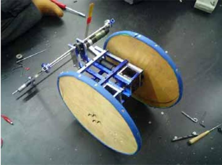
超高級モーター「マクソン」を三台も搭載したマシン。他のマシンとは比べて非常に大きな車輪で、障害物を越えます。車輪の回転はとてもゆっくり。その分、確実に得点していこうというコンセプト。
